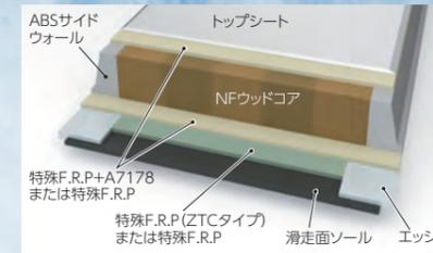
特殊 F.R.P.、A7178 など強化したシートを芯材（ウッドコア）の上下にラミネートした積層構造で、スキーでは最も基本的な構造です。サンドウィッチ構造は、全ての構成材がラミネート状態となっているため、スキーのたわみに対して最も内部歪みの発生しにくい構造となります。このため、スキーの上面に加わる力をそのままダイレクトに雪面に伝えることができます。更に、ターン中はその力をキープすることができるため、オーソドックスでマイルドなスキーになります。
