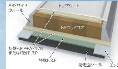
基本的には、サンドウィッチ構造をベースに上面の両角に段差をつけることにより、外部から受ける衝撃を軽減させ、フォルムをより洗練させた構造です。
