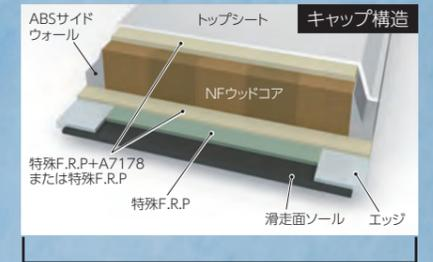
独自開発のサンドウィッチ & キャップ構造です。センター部は『キャップ構造』で高トーション性を、トップ部とテール部は『サンドウィッチ構造』で高フレックス性を出し、さらにトップからテールの全長にわたり衝撃吸収に優れた ABS サイドウォールを配してトーション、フレックス、ダンパーのトリプル効果を発揮する複合構造です。
